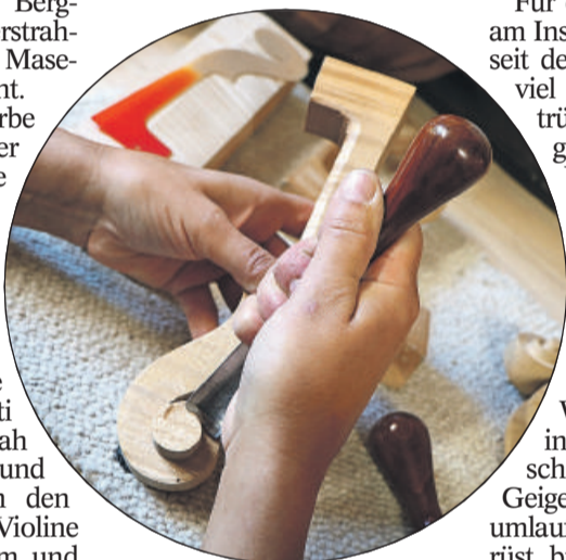
Mit Halseisen wird die Visitenkarte der Geige – die Schnecke – geformt.
