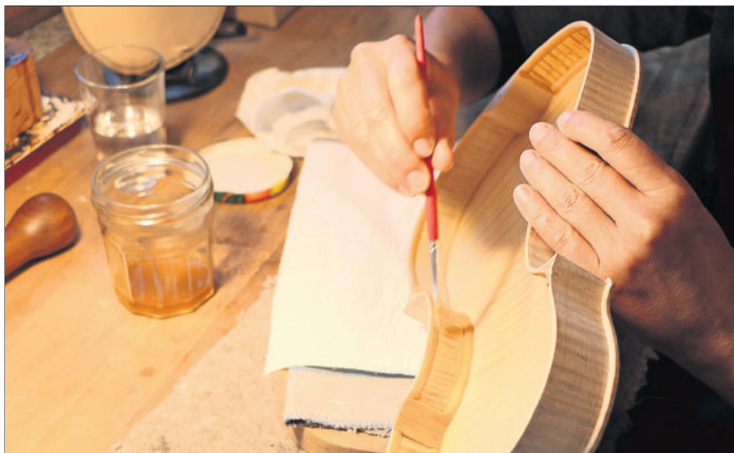
Alten Charme verleiht die Kurkuma-Lösung dem rohen Holz (links). Kaum eine Geige in Uta Böhm's Bühler Werkstatt gleicht einer anderen.
