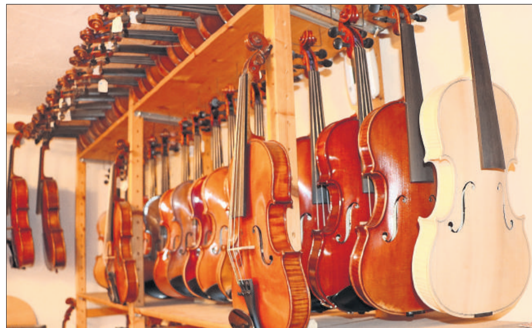
Alten Charme verleiht die Kurkuma-Lösung dem rohen Holz (links). Kaum eine Geige in Uta Böhm's Bühler Werkstatt gleicht einer anderen.
